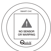
AVVISO SENSORE NON RILEVATO O ATTIVAZIONE TONNEGGIO
